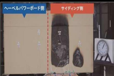
【実際の防火試験体の裏側】
